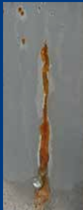
Sinkkiepoksi ja AvantGuard®-tekniikka (986 tuntia)
